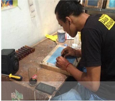
Gambar 4. 4 Proses penyablonan produk pada stasiun kerja penyablonan
