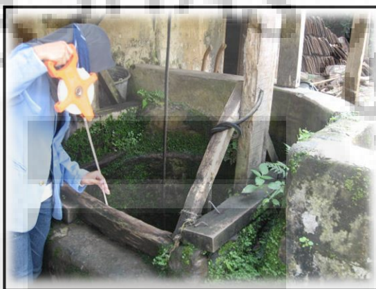
Foto 4.4 Pengukuran Kedalaman Muka Air Tanah
