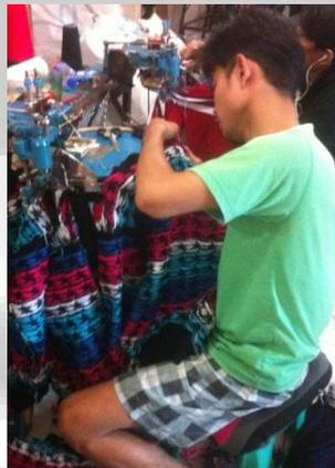
Gambar 4. 5 Proses *linking*
