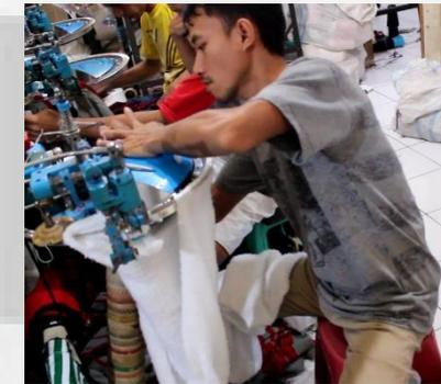
Gambar 4. 16 Proses memasukkan pakaian setengah jadi ke jarum-jarum *linking*
