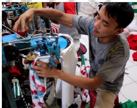
Gambar 4. 22 Proses memutarakan pakaian setengah jadi yang berada pada mesin *linking*
