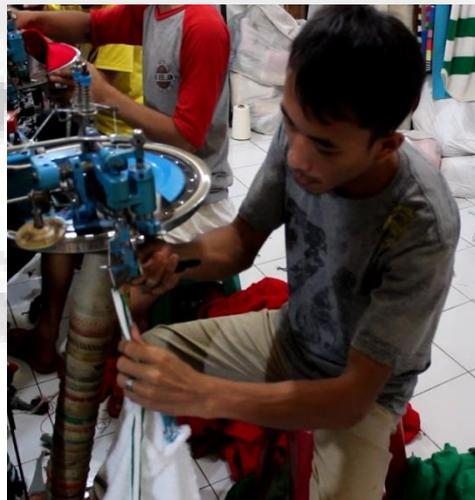
Gambar 4. 24 Proses menggunting benang sisa *linking*
