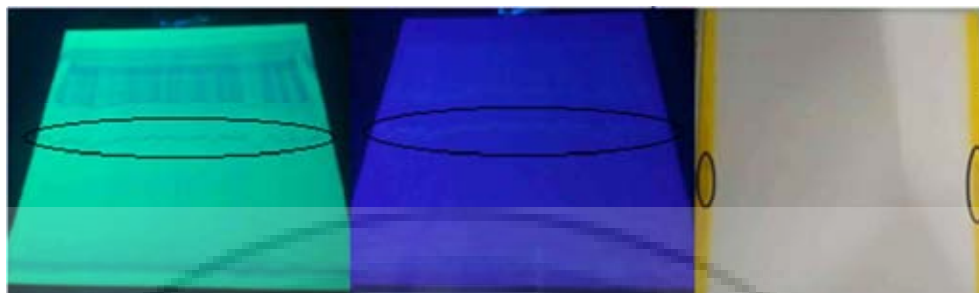
Gambar V.3 Pola pemisahan hasil pemurnian dengan KLT preparatif (a) Dibawah sinar UV 254nm, (b) Dibawa sinar UV 365nm, (c) Setelah disemprot penampak bercak Dragendorff.
