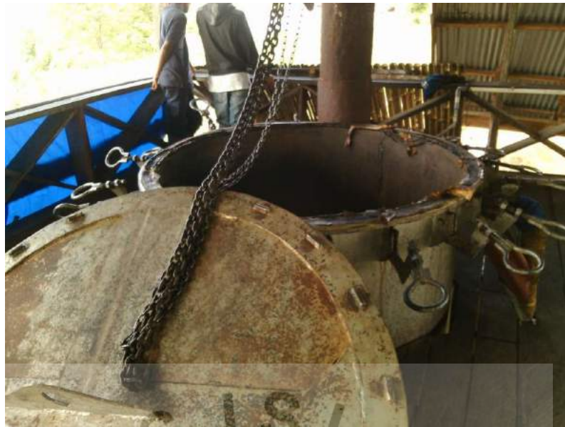
Gambar 5.16 Ketel penyulingan sereh wangi di Desa Pagar Gunung Mandailing Natal
