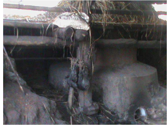
Gambar 5. Penyulingan minyak sereh wangi di Kampung Palugon Cilacap Jawa Tengah
